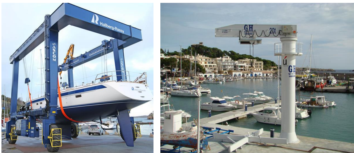
Figura 5.1. gru a portale (travel lift, sx) e Gru a bandiera (jib crane, dx)
