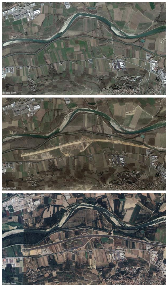
Figura 184. Cantiere per la realizzazione di una nuova infrastruttura viaria (consumo di suolo, 27 ettari) a Roddi in provincia di Cuneo (Piemonte). L'immagine in alto è riferita al 2020, quella al centro al 2022 e l'ultima è l'aggiornamento attuale al 2023
