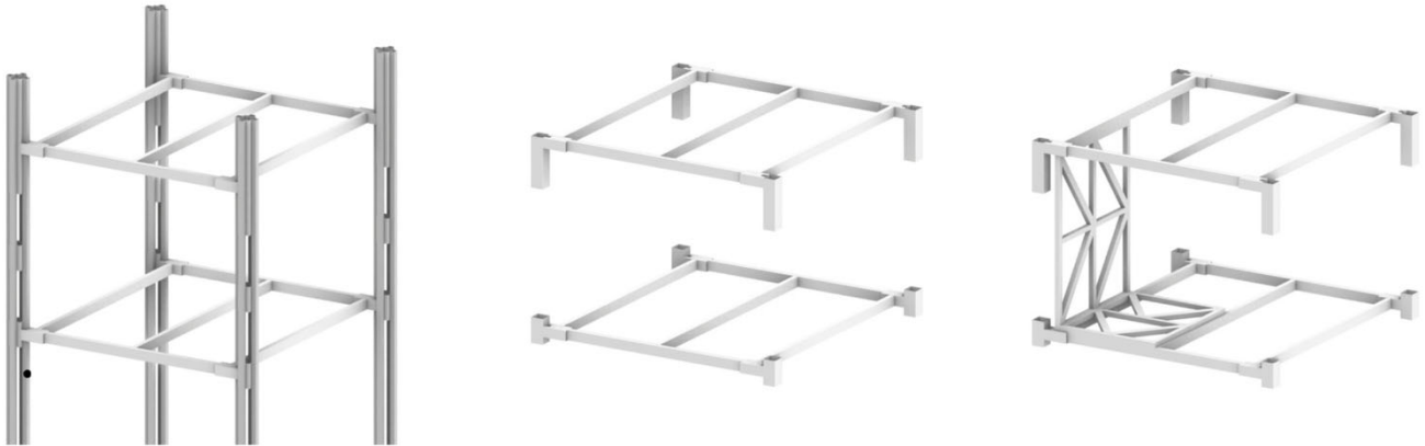
Travi in acciaio connesse con i pilastri in legno per sostenere le capsule
