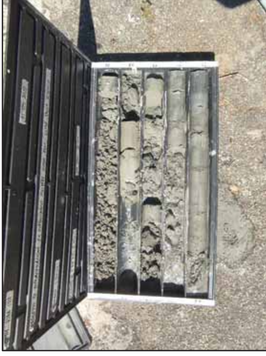
Foto n.23: SDH-01 – Dettaglio cassetta 6 da 25,0 a 30,0 m
