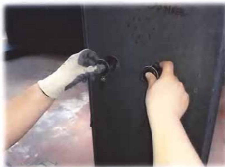
Esecuzione delle misure ultrasoniche
