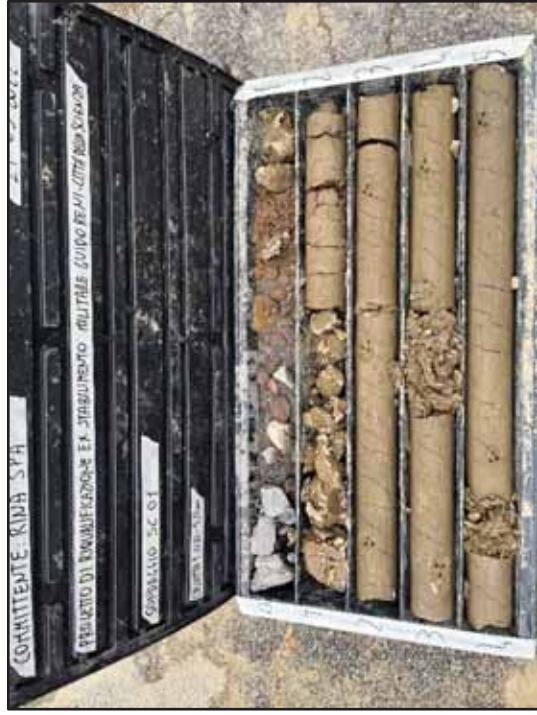
Foto n.6: SCS-01 – Dettaglio cassetta 1 da 0,0 a 5,0 m
