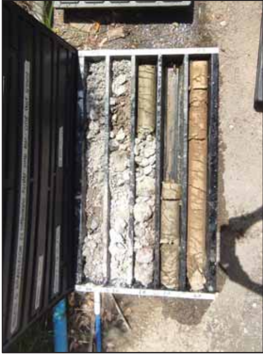
Foto n.13: SDH-01 – Dettaglio cassetta 1 da 0,0 a 5,0 m
