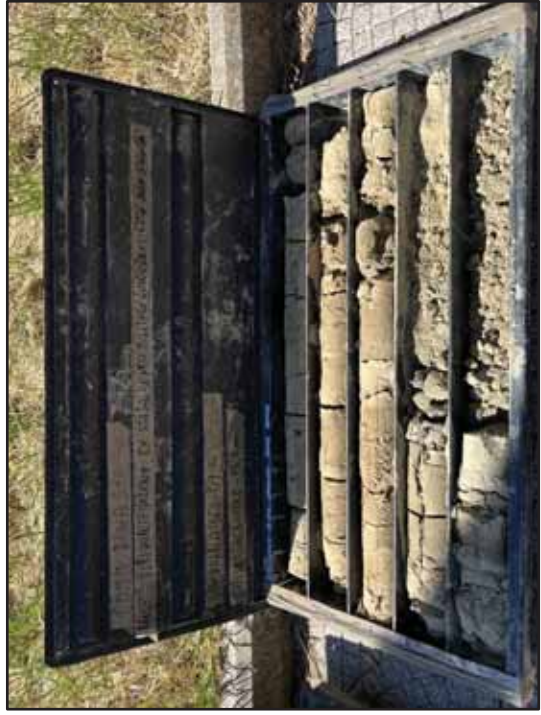
Foto n.10: SCS-01 – Dettaglio cassetta 3 da 10,0 a 15,0 m
