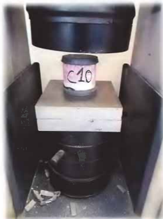
Vista di alcuni provini sottoposti alla prova di compressione
