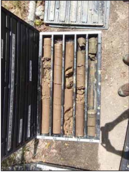
Foto n.15: SDH-01 – Dettaglio cassetta 2 da 5,0 a 10,0 m
