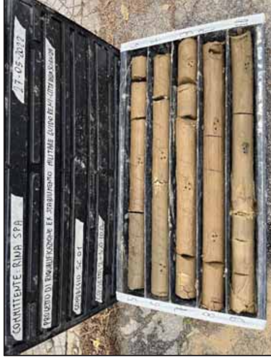
Foto n.8: SCS-01 – Dettaglio cassetta 2 da 5,0 a 10,0 m
