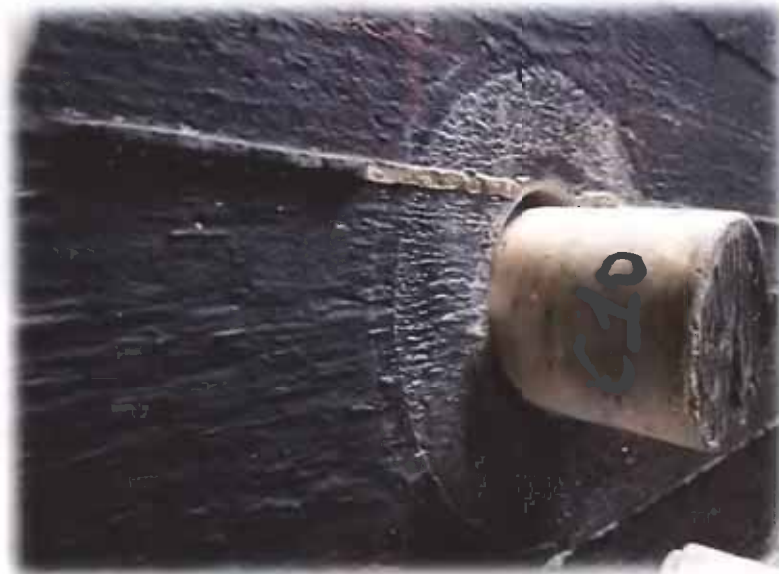
Esecuzione dei prelievi di cls
