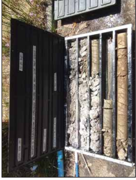
Foto n.12: SDH-01 – Cassetta a da 0,0 a 5,0 m
