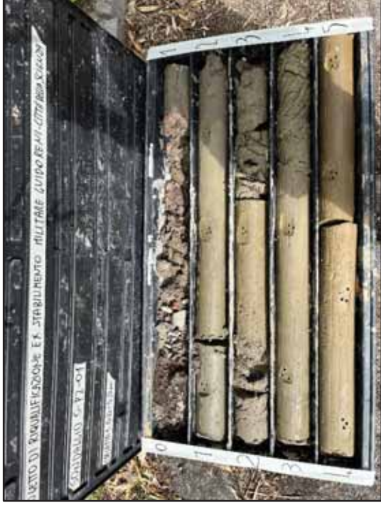
Foto n.3: SPZ01 – Dettaglio cassetta 1 da 0,0 a 5,0 m
