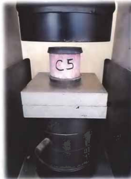
Vista di alcuni provini sottoposti alla prova di compressione
