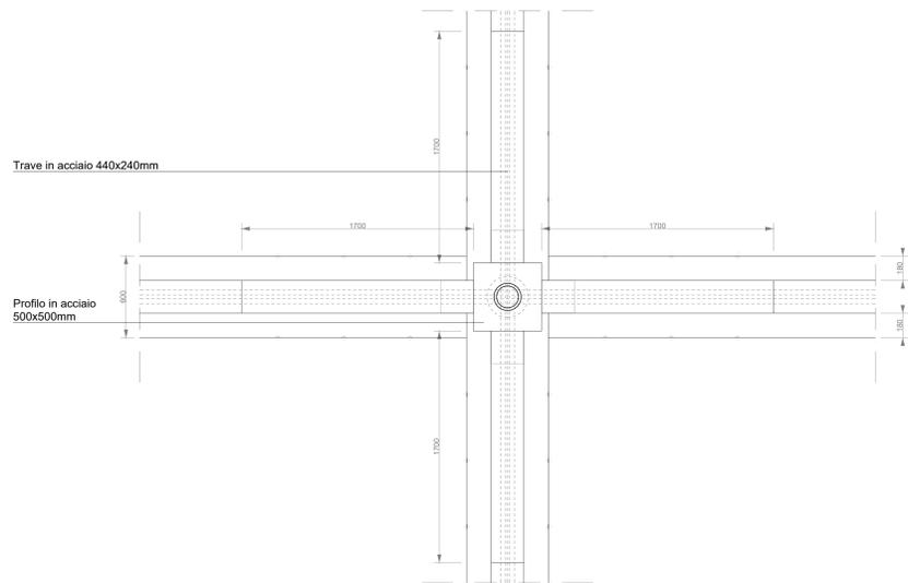
03 Dettaglio Struttura Pilastro
